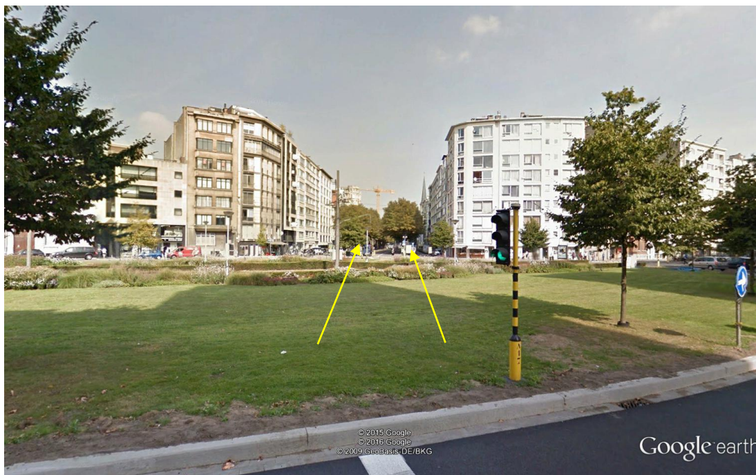
Figuur 4. Op de foto is te zien hoe de bomen (gele pijlen) sterk beschut staan door de omringende gebouwen. Bovendien beschutten ze elkaar. Hierdoor werd met een erg grote correctiefactor voor beschutting gerekend (0,6).
